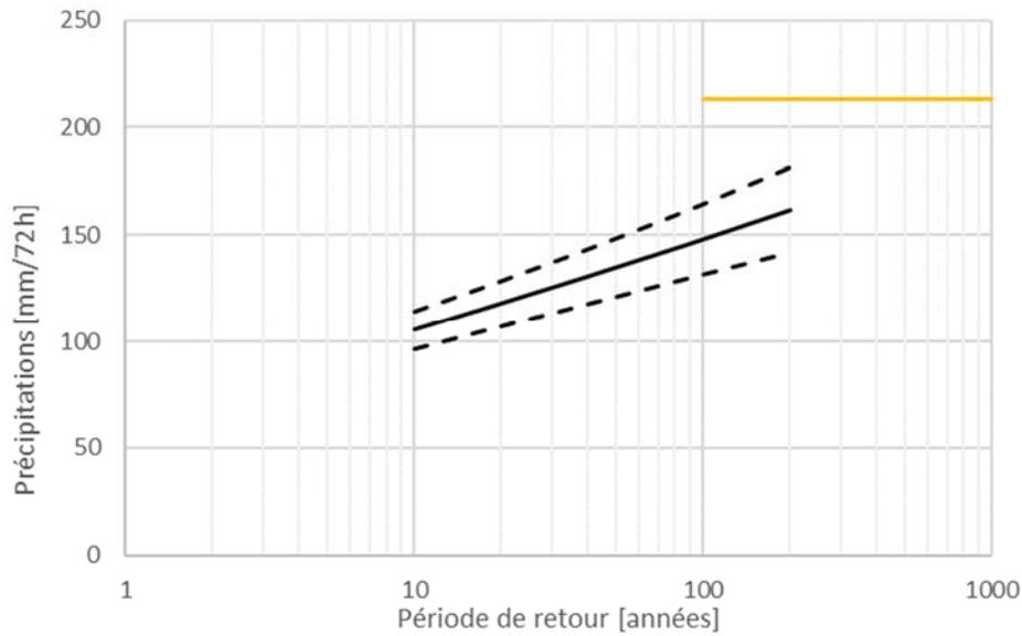
Figure 9-9: Situation : Mont-Rigi. Courbe IDF pour les maxima sur 72h avec intervalle de confiance de 95% et indication du cumul de précipitation maximum sur 72h de l'événement de juillet 2021.
