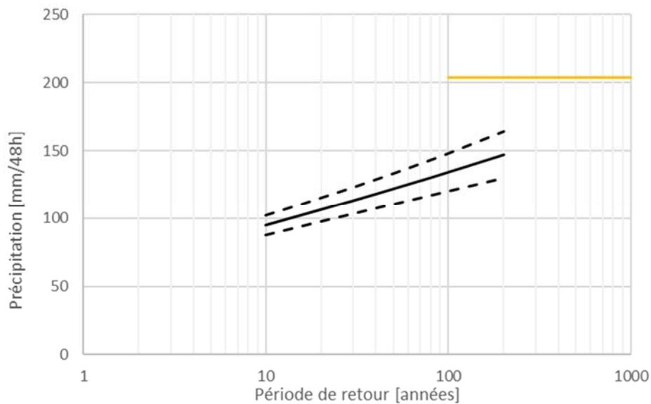
Figure 9-8: Situation : Mont-Rigi. Courbe IDF pour les maxima sur 48h avec intervalle de confiance de 95% et indication du cumul de précipitation maximum sur 48h de l'événement de juillet 2021.
