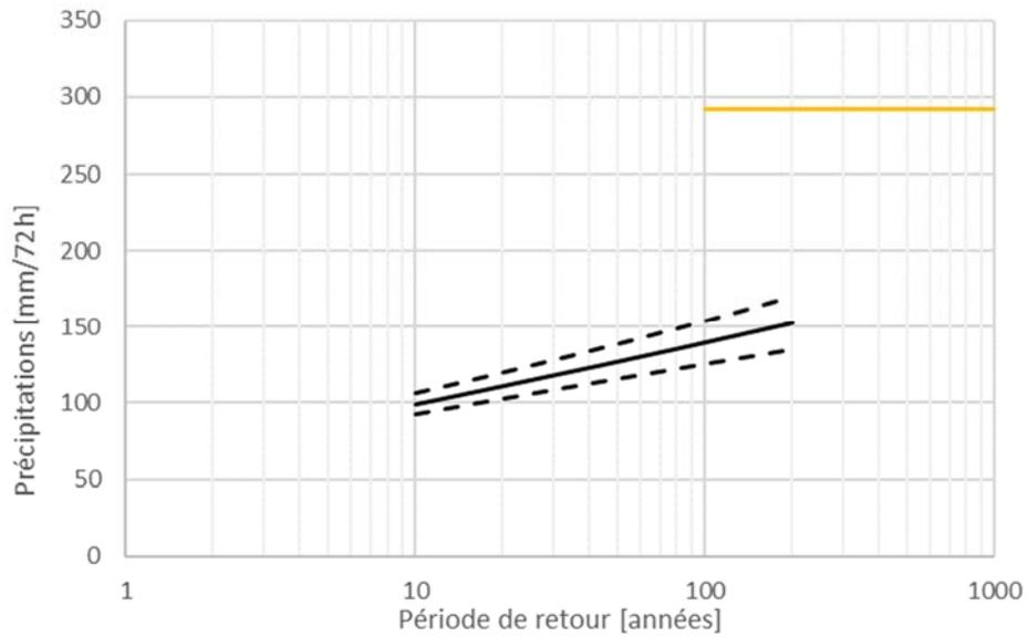
Figure 9-3: Situation : Jalhay. Courbe IDF pour les maxima sur 72h avec intervalle de confiance de 95% et indication du cumul de précipitation maximum sur 72h de l'événement de juillet 2021.
