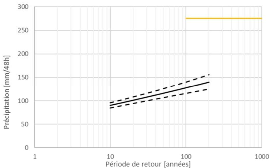
Figure 9-2: Situation : Jalhay. Courbe IDF pour les maxima sur 48h avec intervalle de confiance de 95% et indication du cumul de précipitation maximum sur 48h de l'événement de juillet 2021.
