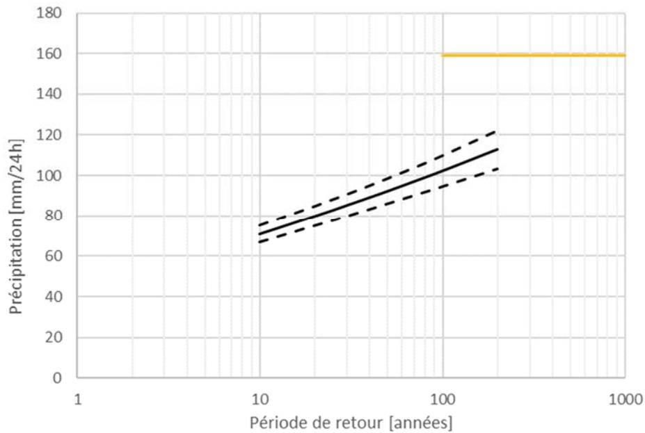
Figure 9-7: Situation : Mont-Rigi. Courbe IDF pour les maxima sur 24h avec intervalle de confiance de 95% et indication du cumul de précipitation maximum sur 24h de l'événement de juillet 2021.
