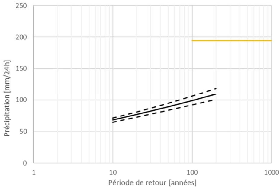
Figure 9-1: Situation : Jalhay. Courbe IDF pour les maxima sur 24h avec intervalle de confiance de 95% et indication du cumul de précipitation maximum sur 24h de l'événement de juillet 2021.
